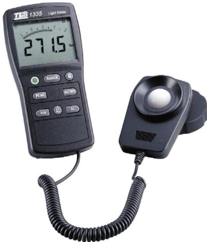
Para la medición de la cantidad de luz emitida por la iluminación de un determinado local se emplea el luxómetro. Este equipo está formado por un sensor, el cual se colocará a la altura donde deseamos conocer el valor de la iluminancia.
