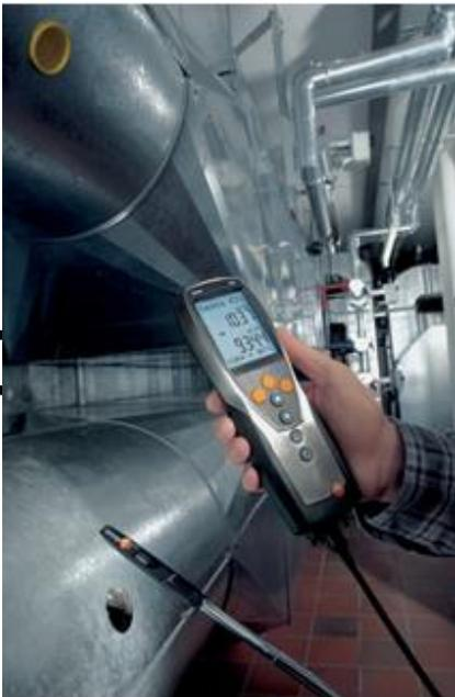
Mediante el equipo multifunción Testo 435-2, acoplándole la sonda adecuada, también se puede medir la velocidad de aire a través de un conducto de ventilación.
